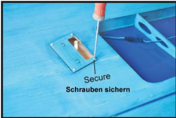
RUDERHORN FÜR WÖLBKlappe ANBRINGEN INSTALLING THE FLAP CONTROL HORN
